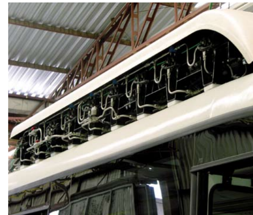
DETALHE DOS TANQUES DE HIDROGÊNIO DO ÔNIBUS BRASILEIRO Fonte: Carlos Zundt - 2008.
