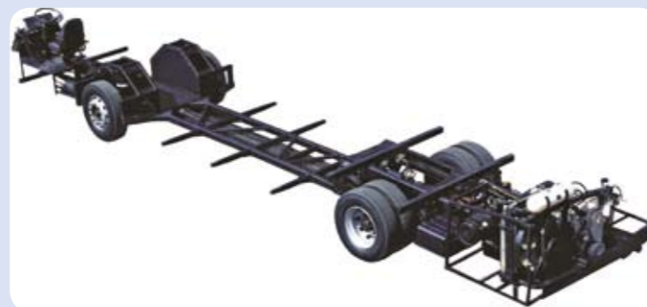
CHASSI PARA ÔNIBUS TRADICIONAIS E ESPECIAIS – ESPECIALIDADE BRASILEIRA Fonte: Scania Latin América - 2008.
